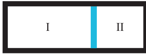
Figure 16.3: 断熱ピストン (青) で仕切られた断熱壁からなる箱
